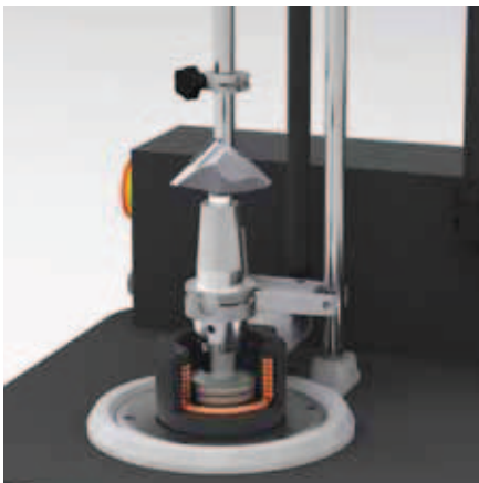
Bild1: Einsetzen Werkzeugträger Image1: Inserting tool adapters
